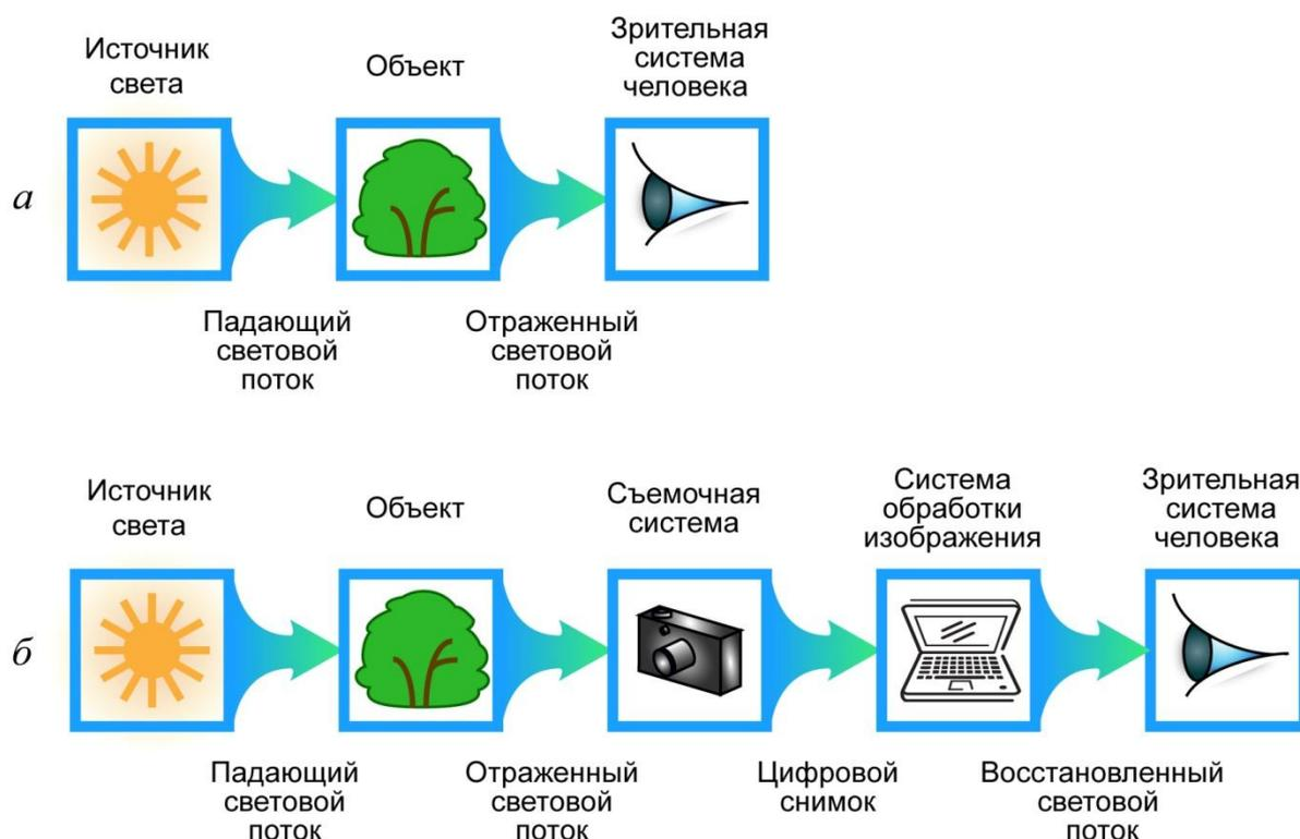
Рис. 1.2.1. Основные звенья передачи информации: а – при непосредственном наблюдении объекта; б – при цифровой фотосъёмке
