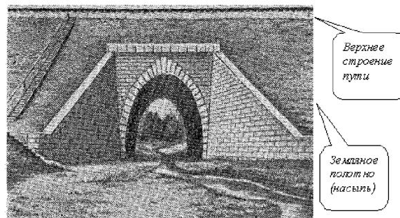
Рис. 22. Водопропускная труба [21, с. 41]
