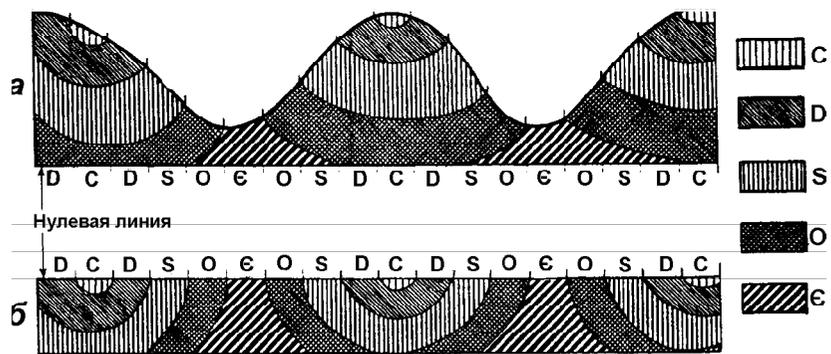
**Рис. 33.** Геологический профиль участка со складчатой структурой: а – на топографической основе; б – без топографической основы
