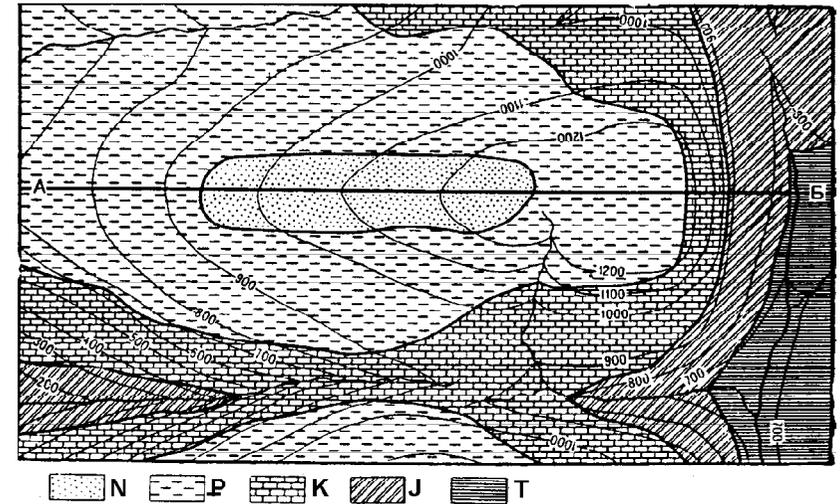
**Рис. 28.** Геологическая карта с наклонным залеганием пластов. А-Б – линия профиля, построение которого показано на рис. 29
