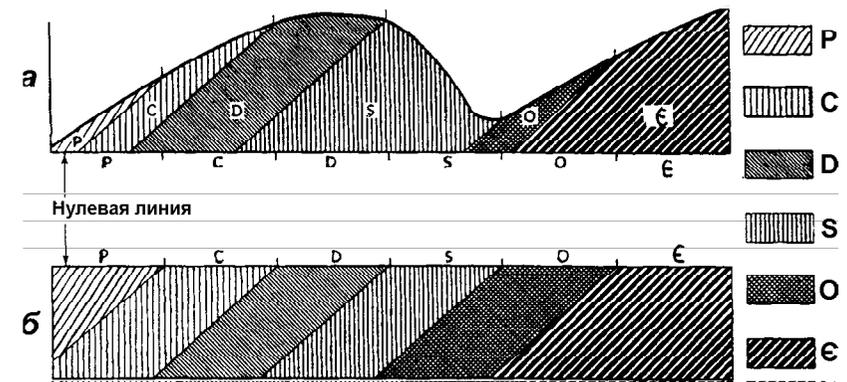
Рис. 32. Геологический профиль участка с наклонным залеганием пластов: а – на топографической основе; б – без топографической основы
