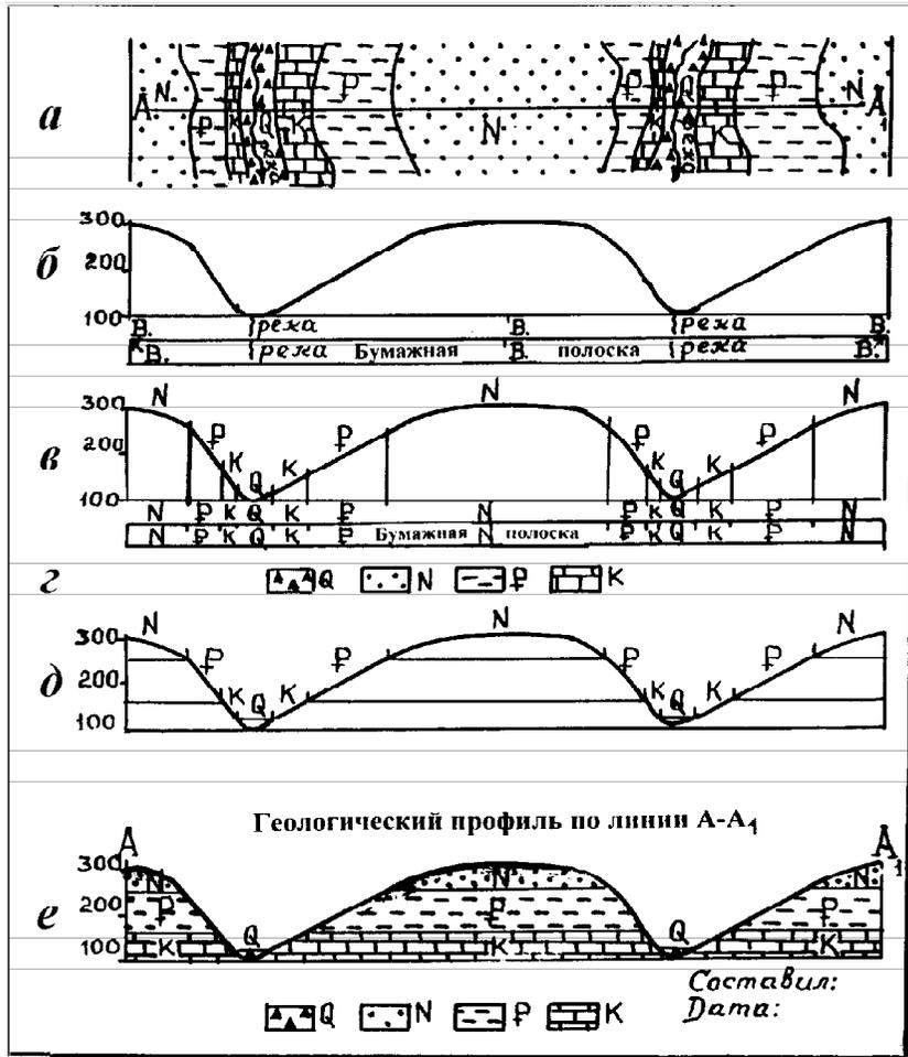
Рис. 30. Последовательные стадии построения геологического профиля по карте без горизонталей: а – геологическая карта с нанесенной на ней линией профиля А-А<sub>1</sub>; б-е – стадии вычерчивания профиля
