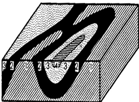
**Рис. 25.** Блок-диаграмма участка со складчатым залеганием пластов и нерасчлененным рельефом (вверху); горизонтальный срез и профили складок с ундулирующими (поднимающимися и опускающимися) шарнирами (внизу)
