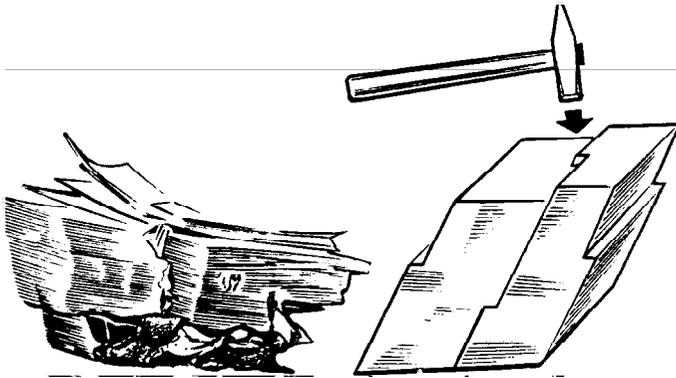
**Рис. 2.** Спайность весьма совершенная в одном направлении (слюда, слева) и совершенная в трех направлениях (кальцит, справа)
