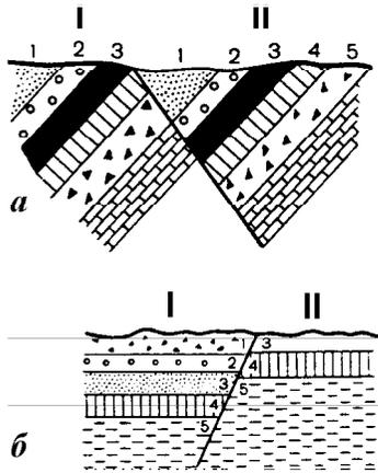
**Рис. 27.** Поперечный разрез участков, пересеченных сбросами: а – выход пластов повторяется; б – на один гипсометрический уровень по обе стороны от линии сброса выведены на поверхность разновозрастные пласты
