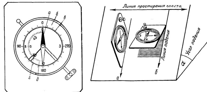
**Рис. 22.** Горный компас (слева): а - магнитная стрелка; б - лимб; в - градуировка на лимбе; г - отвес; д - градуировка для определения углов падения. Определение падения пласта горным компасом (справа): а - определение линии падения и угла падения; б - определение азимута падения пласта
