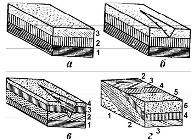
**Рис. 23.** Блок-диаграммы: а – участка с горизонтальным залеганием пластов и нерасчлененным рельефом; б – участка с горизонтальным залеганием пластов и неглубоко врезанной речной долиной; в – участка с горизонтальным залеганием пластов и глубоко врезанной речной долиной; г – участка с наклонным залеганием пластов и нерасчлененным рельефом
