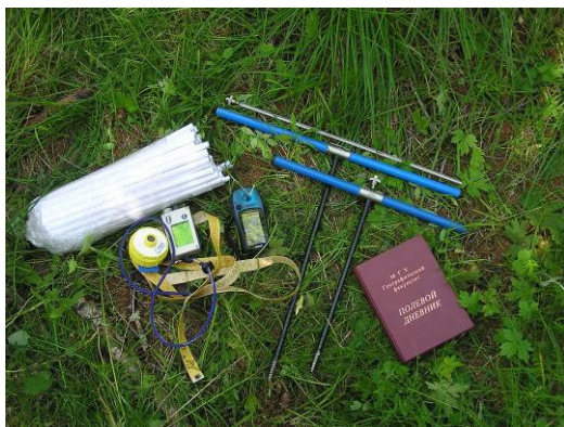
Оборудование: буры Naglof, высотомер Naglof, пробирки, сантиметр, GPS, полевой дневник
