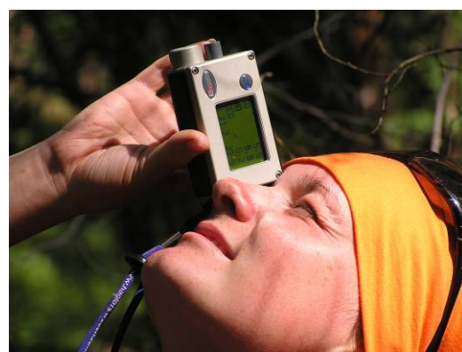
Определение высоты дерева, высотомер Naglof
