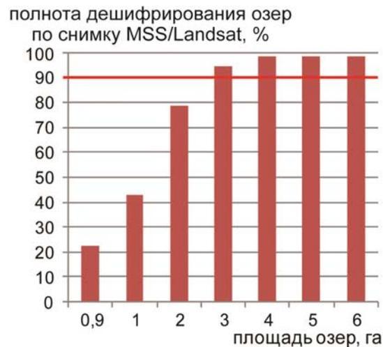
**Рисунок 2.30.** Полнота дешифрирования термокарстовых озер разной площади по снимкам MSS/Landsat относительно снимков ETM+(TM)/Landsat
