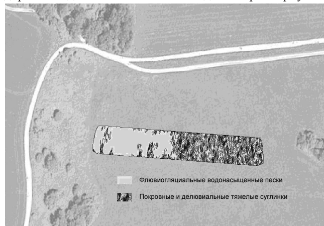
Рис. 3. Координатная привязка линзы водонасыщенных лимногляциальных отложений, обнаруженных георадарной съемкой под покровными суглинками на склоне Сенокосной балки. Приведен горизонтальный срез площадной съемки на глубине 2,5 м
